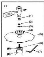
1. Montati axul lamei de taiere in imbinarea cu roti dintate si insurubati fix cu cheia in forma de L
